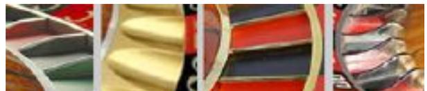
Sulla base della casella viene incollato un panno micrometrico di feltro per determinare i colori delle caselle. Anche questi elementi erano soggetti ad usura e tendevano a scollarsi, attutendo il rimbalzo della pallina.
