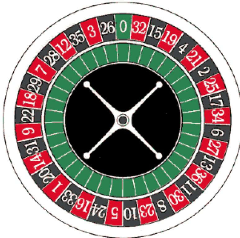
Il cilindro è composto da una parte fissa ed una parte mobile che poggia su cuscinetti a sfera. Nella parte fissa (concava) sono posizionate delle losanghe (piccoli rombi) alternate in verticale ed orizzontale per interrompere la rotazione della pallina e rendere più casuale la sua corsa.
